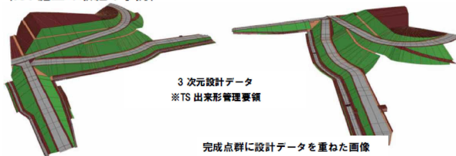
TLSによる出来形測量
