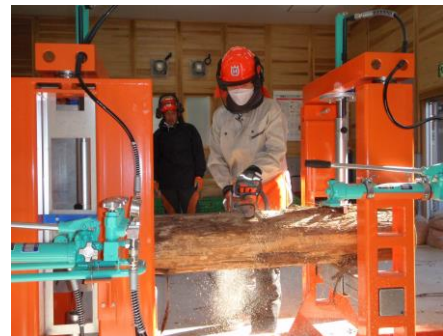
図3 風倒木伐採練習装置を使用した研修
