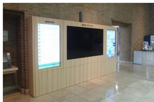
県産材を使用した極薄の木質シートでラッピングした案内モニター（県庁玄関ホール）
