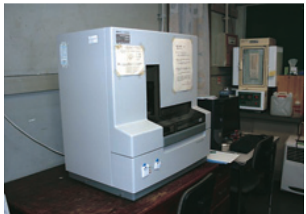
キャピラリー電気泳動装置
