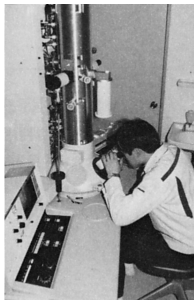
写真1-3-4 病虫科電顕室に設置された透過型電子顕微鏡（1985）
