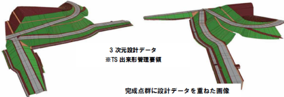
TLSによる出来形測量
