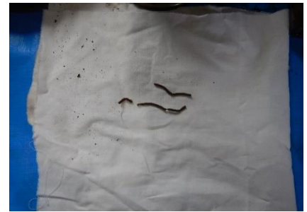
腐食し破損したオイルシールのバネ
