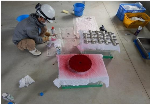
PT検査の様子
