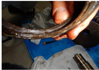
破損したオイルシール
