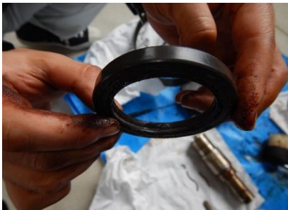
破損したオイルシール
