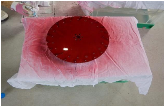
回転板に浸透液を塗布(両面)
