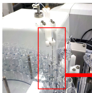
試料採取部から自動的に試料が吸引されている様子
