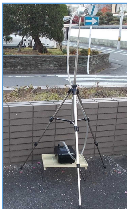
写真：アスベスト捕集を行う機器 ポンプで空気を吸引し、上部にセットしたフィルターにアスベストなどの粉じんを捕集する。
