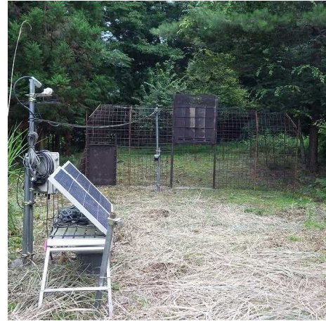
捕獲檻遠隔監視システム
