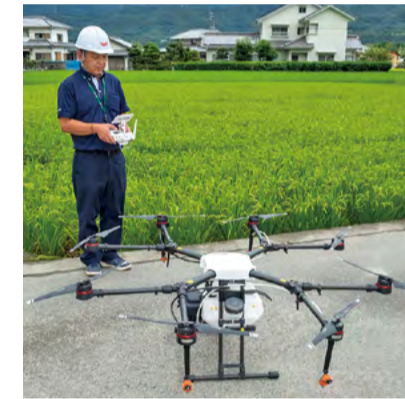
●農業用ドローンで、農地の散布作業を効率化しています。
