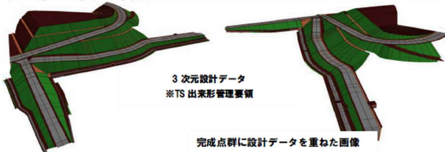
TLSによる出来形測量
