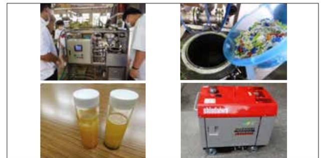
自然災害の一因と考えられている「プラスチックゴミ」から「油」を作ることが出来る「プラスチックゴミ油化装置」を製作し、出来た油を「バイオディーゼル発電機」に入れて電気を作る。すなわち、不要な「プラスチックゴミ」から電気を作ることが出来る。
