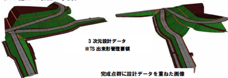
TLSによる出来形測量
