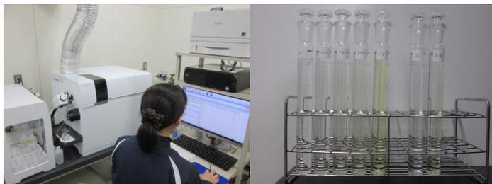
左: ICP-MS による金属類の分析
