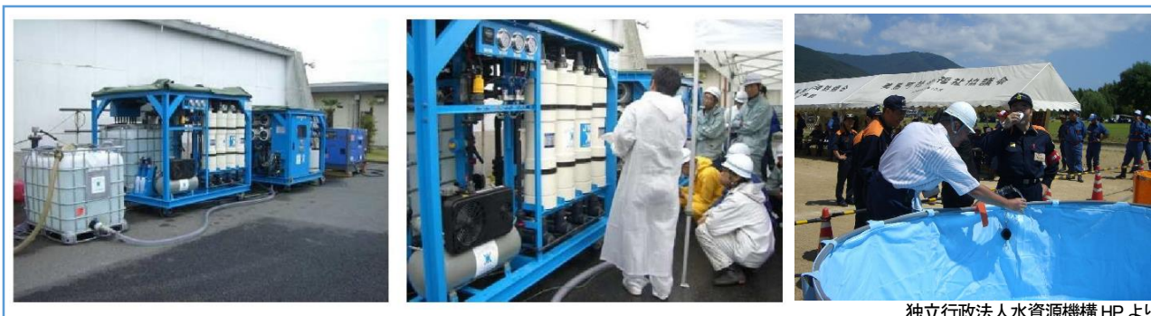
施策2-3 海水淡水化装置による飲料水の製造
