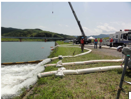
排水ポンプ車操作による内水排除
