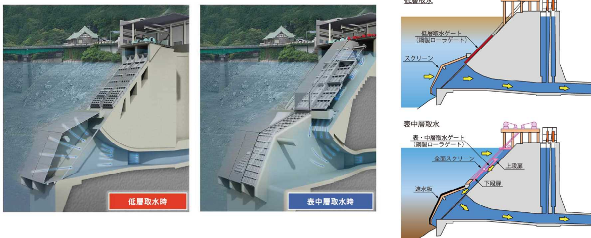
図 5-7 選択取水のイメージ（左：取水設備、右：選択取水）
