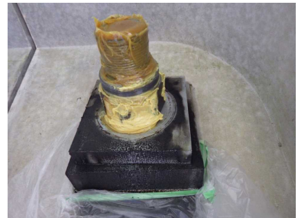
③ キャップ取外し後(油劣化)
