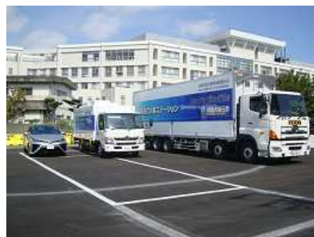
移動式水素ステーション
