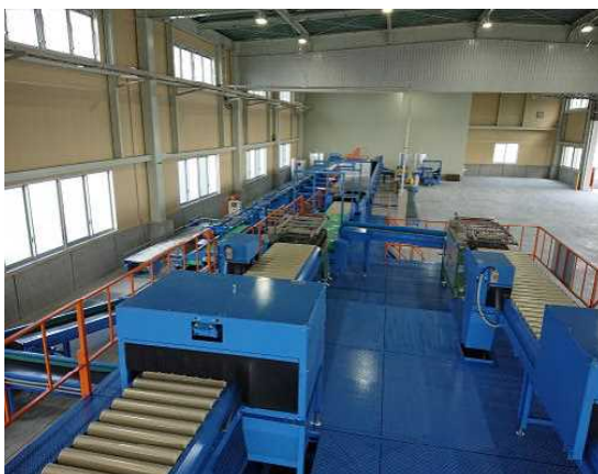
大根の洗浄から等級選別までの工程を自動で行う共同選別施設（JA大津松茂）
