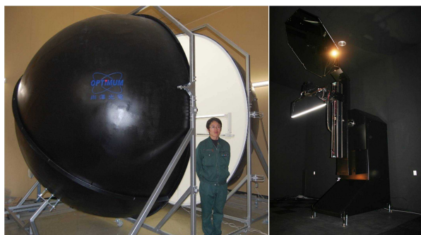
LED応用製品性能評価機器 (左図:全光束測定装置、右図:配光測定装置)
