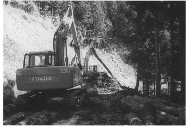
スイングヤーダとプロセッサによる間伐材生産状況
