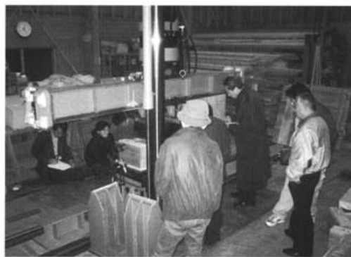
木造軸組工法の強度試験（実大強度試験棟）
