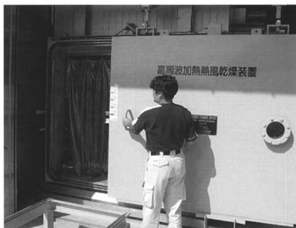
徳島すぎの低コスト乾燥試験（住宅資材性能試験棟）
