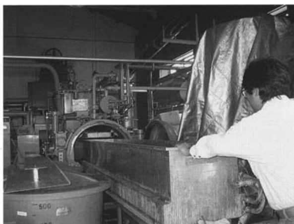
間伐材の保存処理試験（新技術開発試験棟）
