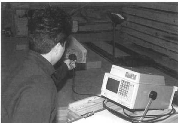
縦振動法による曲げヤング係数測定
