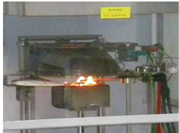
図2 コーンカロリーメーターによる発熱性試験
