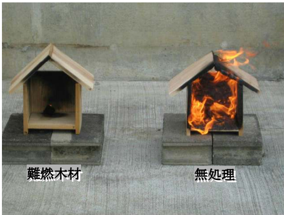
図1 模型による燃焼試験
