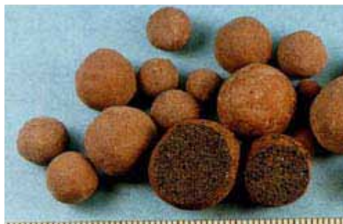
人工軽量骨材。軽量コンクリートの材料として利用される。
