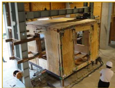
県産材を活用した耐震シェルター
