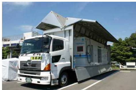
移動式水素ステーション
