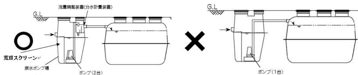
図7-1-6 流入ポンプ槽の良否の例
