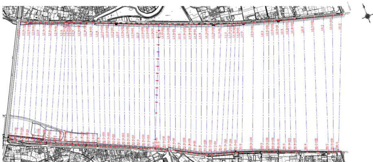
図 3.4-3 深浅測量線（平成 25 年度 測線間隔約 50m）
