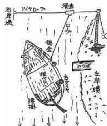
図-3 岡田式渡船と仕組み図(川崎良子氏提供)
