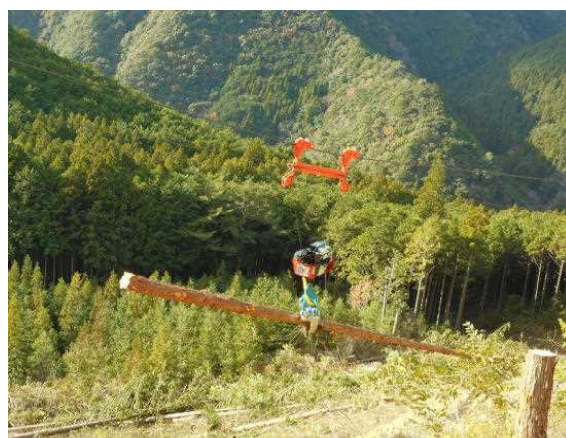
新たな作業システムの構築 (ケーブルグラップル)
