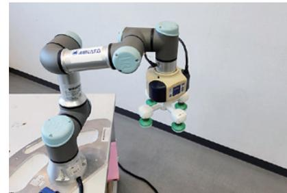
人と同じ空間で安全に作業を行うことが出来るように設計された産業ロボット。「協働ロボット」とも呼ばれる。
