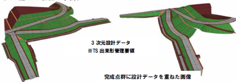
TLSによる出来形測量
