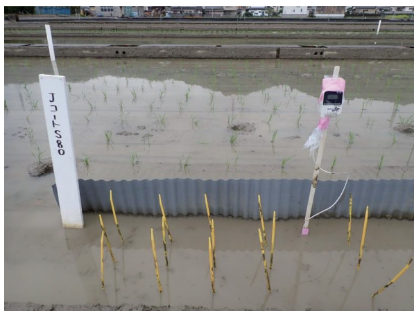
図1 被覆尿素的溶出試験の様子
