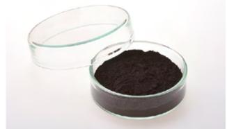
リチウムイオン電池用の正極材料
