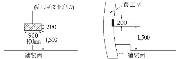
図10-6-1 覆工厚変化箇所の刻示標準図
