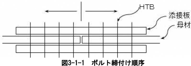
図3-1-1 ボルト締付け順序
