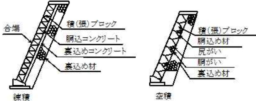
図3-1-5 コンクリートブロック工
