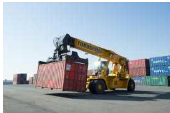
リーチスタッカー
