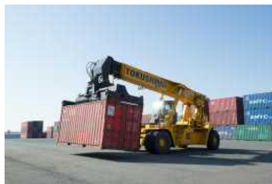
リーチスタッカー
