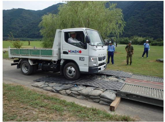
写真 土のうによる段差解消訓練
