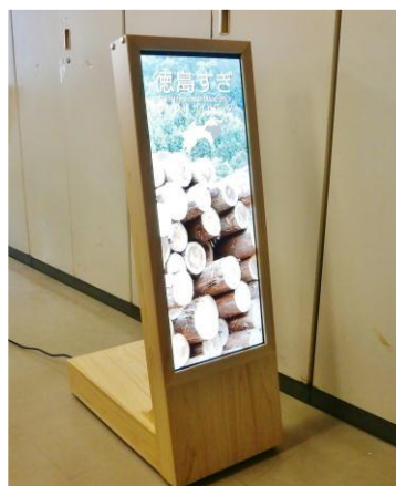
県産材を使用した極薄の木質シートでラッピングしたデジタルサイネージ（イベントや会議で使用）
