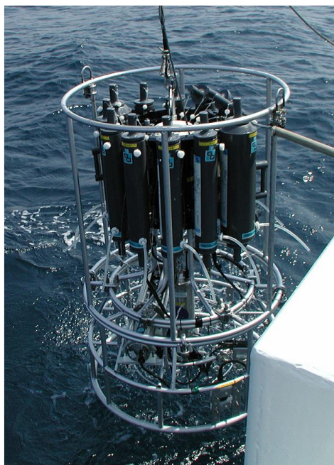
写真3. フレームに取り付けられた CTD(写真下部)と採水装置
