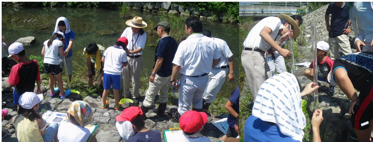
透視度計による明連川と穴吹川の透視度の測定を行い、比較しました。
