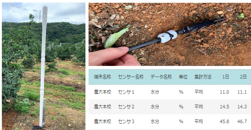
農業大学校の農作業実習で活用した圃場環境観測システム
