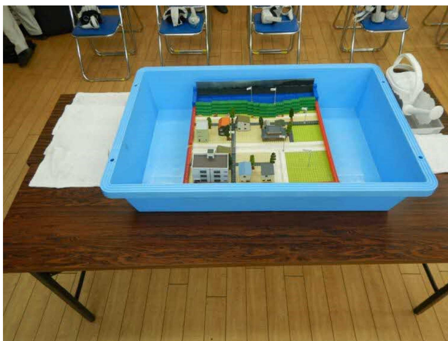
写真：水害模型実験装置（水色箱サイズ B=102.4cm、D=66.4cm：H=20cm）
