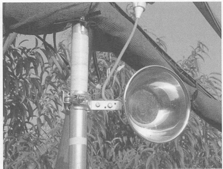
図3 圃場に設置した超音波発振素子
