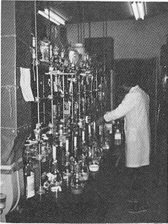
残留農薬の分析 (カラムクロマトグラフィーによる精製)
