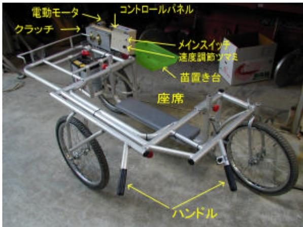
図1 開発した電動作業台車
