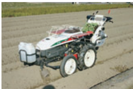
写真1 全自動移植機による定植状況
