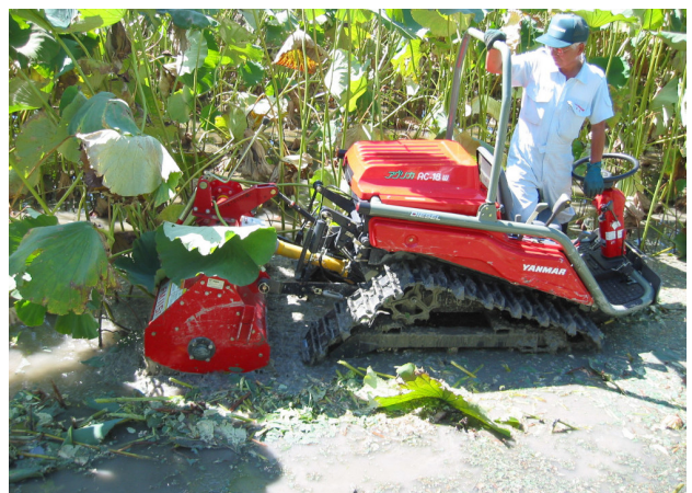
写真2-10-7 レンコン茎葉処理機試験
