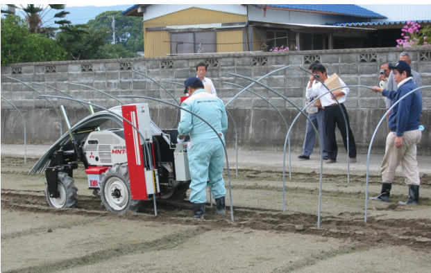
写真2-10-8 トンネル支柱打ち込み機の現地試験
