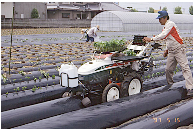
写真2-10-1 サツマイモのセル成型苗移植試験
