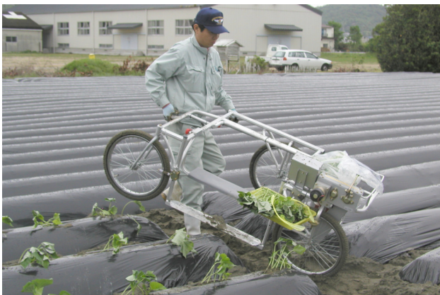
写真2-10-5 サツマイモ挿苗用電動作業台車の旋回操作
