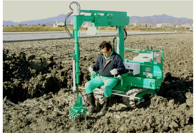
写真2-10-6 レンコン収穫機試作機
